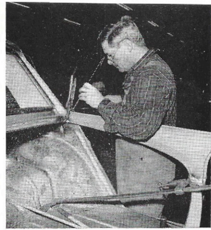
Fig. 55. — Effectuer une soudo-brasure à la jonction tôle latérale.
