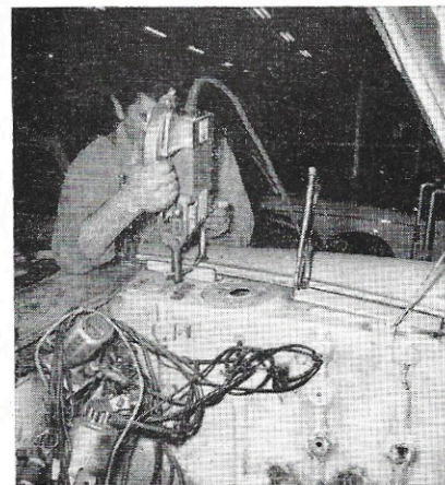
Fig. 85. — Soudage de l'aile sur doublure d'aile avant. Pince ARO - porte-électrodes 253 A.
