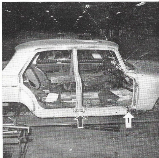
Fig. 39. — Mise en place de l'élément neuf. De façon à assurer une jonction correcte entre le longeron neuf et la partie conservée, opérer la découpe en superposant l'élément neuf sur l'élément conservé.
