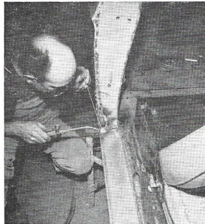
Fig. 106. — Effectuer une soudo-brasure à la liaison bas de marche pied d'entrée.
