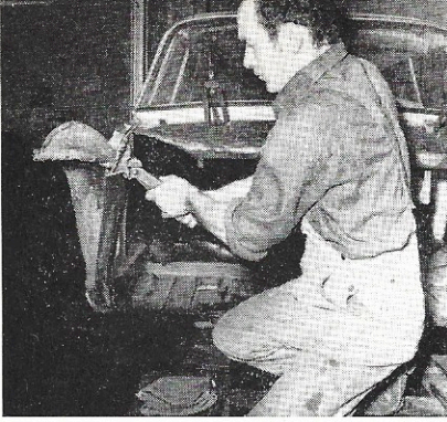
Fig. 12. — Dépose du renfort d'armature.
