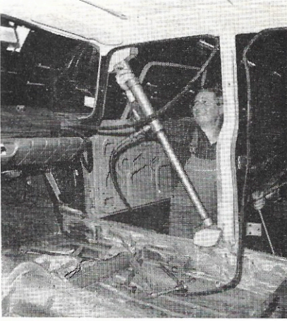
Fig. 31. — Vérinage de l'entrée de porte avant. Remarquer les cales de bois en forme.
