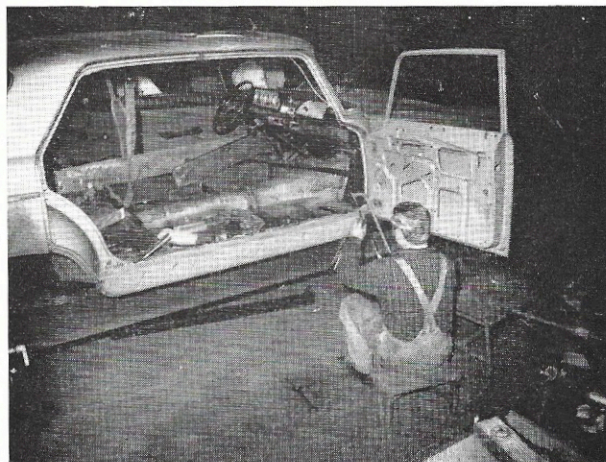
Fig. 39. — Mise en place de l'élément neuf. De façon à assurer une jonction correcte entre le longeron neuf et la partie conservée, opérer la découpe en superposant l'élément neuf sur l'élément conservé.
